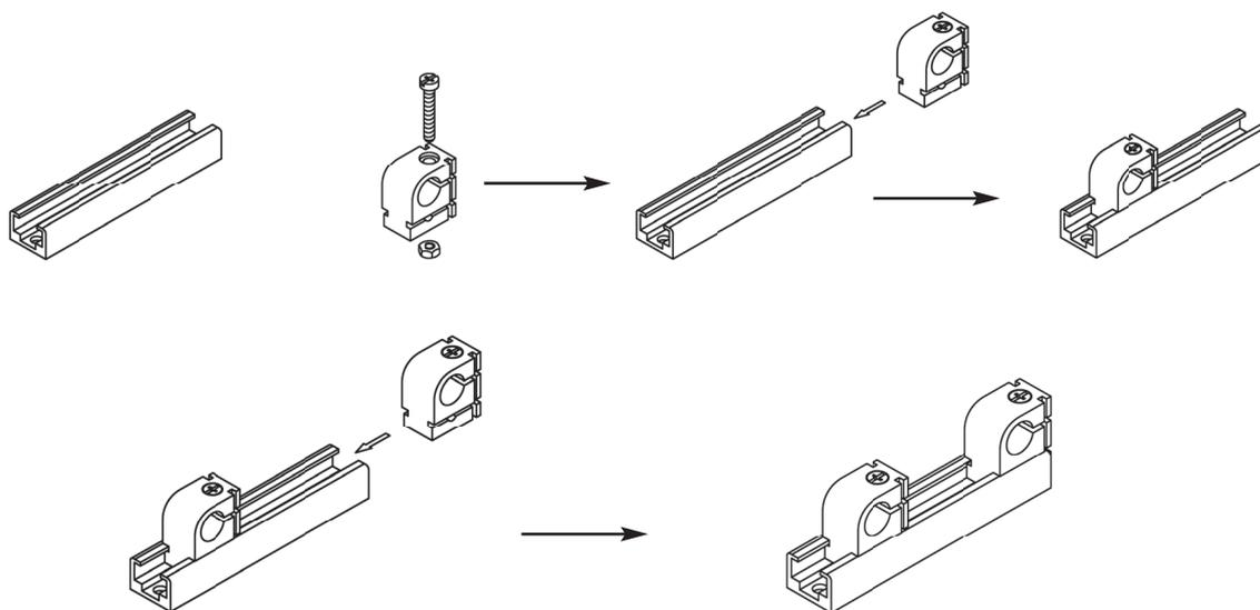
Il sensore può ora essere inserito all'interno dell'insieme composto da supporto più guida. La posizione del sensore può essere regolata spostando il supporto lungo la guida oppure il sensore stesso rispetto al supporto.
